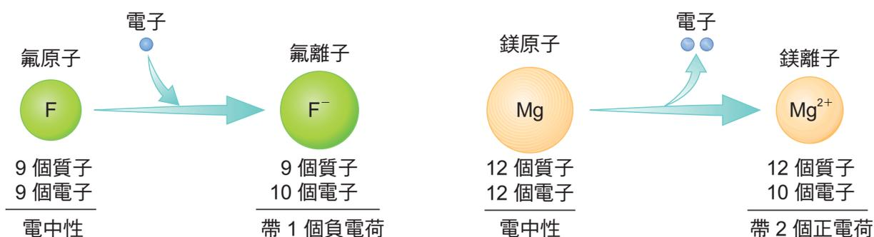
▲ 氟原子 (F) 得到電子成為氟離子 (F<sup>-</sup>)      ▲ 鎂原子 (Mg) 失去電子成為鎂離子 (Mg<sup>2+</sup>)
