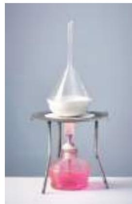
▲ 圖3-30 加熱混合溶液。
