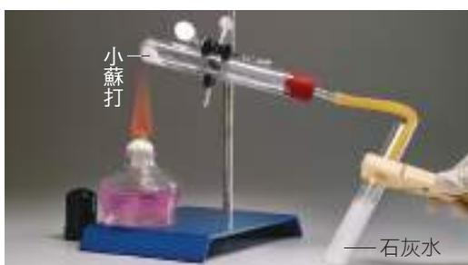
▲ 圖3-41 以酒精燈加熱裝有小蘇打的試管。
